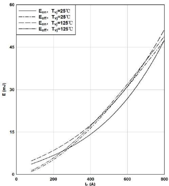
开关损耗 (典型), IGBT(T3), 逆变器
