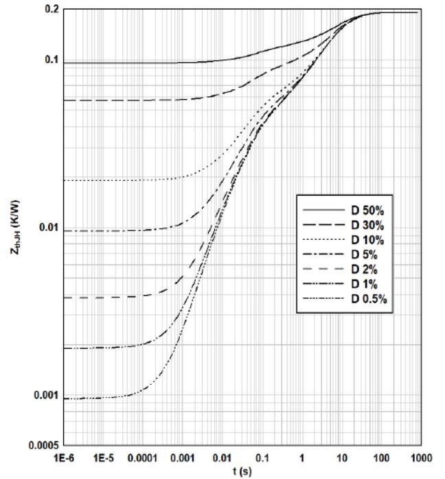
瞬态热阻抗, 二极管(D1/D4/D5/D6)
